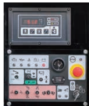
旋回台部操作盤 新型AMCを装備
