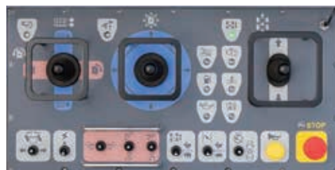
デッキ部操作盤
