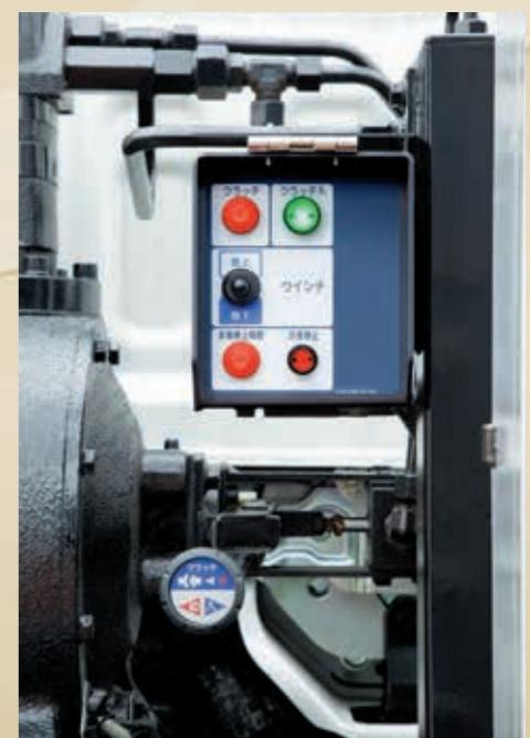
2t(19.6kN)×2本掛けのオートクラッチ内蔵式ウインチを用意。操作に連動して自動的にクラッチが接続するので、切換作業が必要ありません。さらに特定小電力型ラジコンの標準装備により、ウインチの巻上げ・巻下げ、アクセル、非常停止の操作がカンタンに安全な場所から行えます。またウインチサイドには非常時用のスイッチボックスを装備しています。
