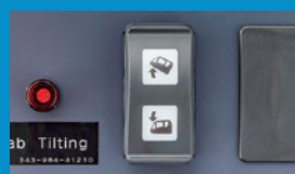
Kabinen-Neigungs- anzeige und Schalter
