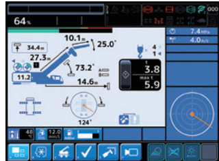
Voreingestellte Menüanzeige (im Kranbetrieb)
