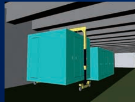
⑤ 地下など狭い場所での据え付け作業
