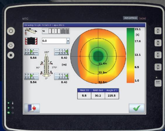
On-Board-Simulation mit dem IC-1 Plus Steuerungssystem
