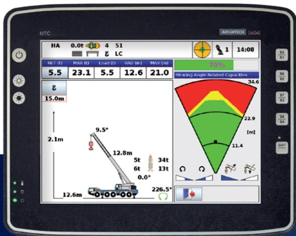
Tragfähigkeitsradar IC-1 Plus
